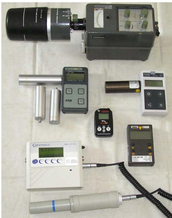
Abb. 2-4: Beispiele für Ortsdosisleistungsmessgeräte
