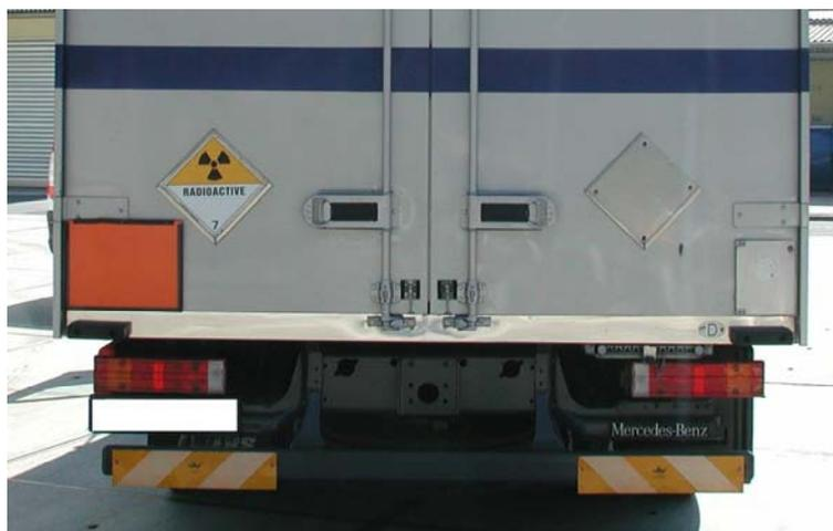
Abb. 2-3: Lieferfahrzeug für den Transport gefährlicher Güter mit der Warn-tafel nach GGVS nach Gefahrenklasse 7 „Radioaktive Stoffe“
