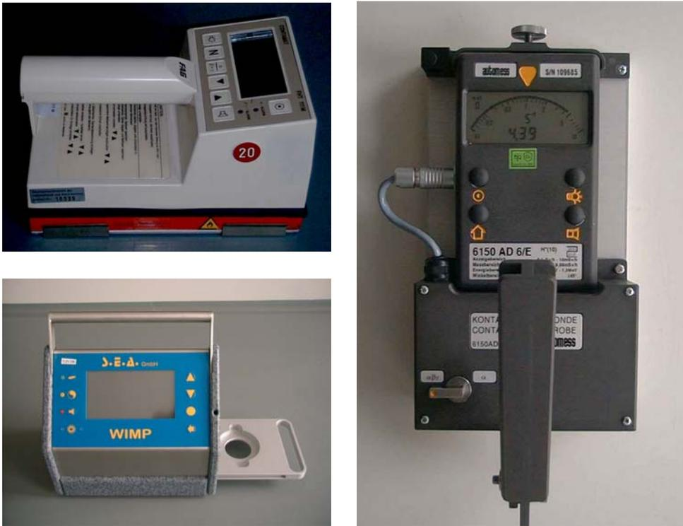
Abb. 2-5: Beispiele für Messgeräte zur Kontaminationskontrolle
